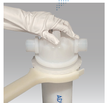
4 レンチを用いてロックングナットを指定のトルク値まで締め付ける
