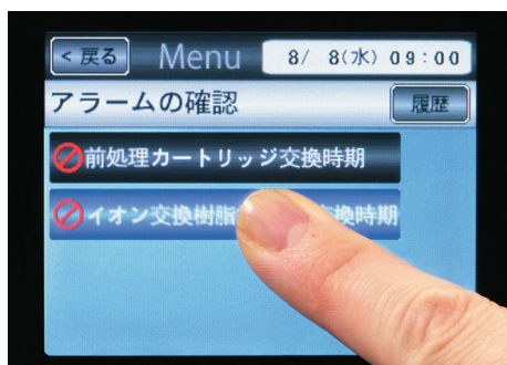
アラームの一覧表示画面で、内容を知りたいアラームをタッチすると、そのアラームの詳細内容が表示されます。
